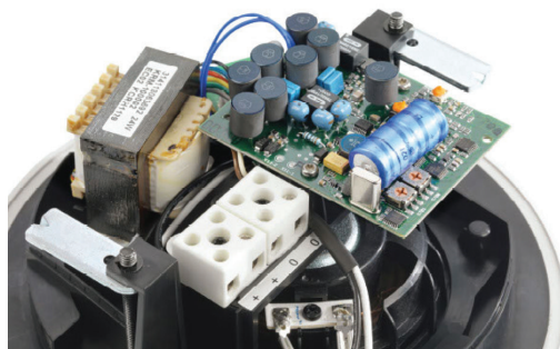
Widok z tyłu głośnika LC4-UCxxE wraz z miejscem na instalację opcjonalnej karty nadzoru poprawności działania linii
